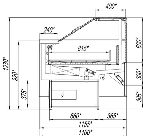
Рисунок 6 сечение витрины SKYE H
