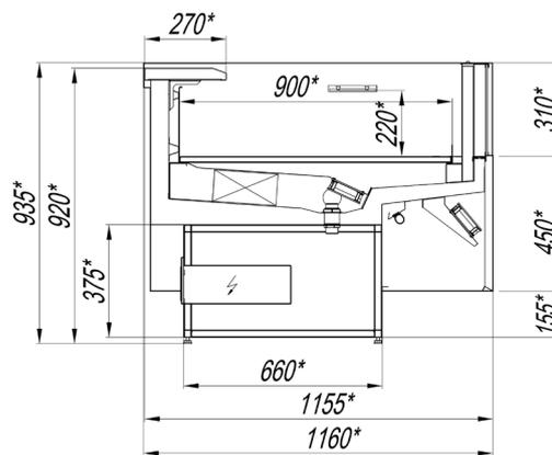
Рисунок 3 сечение витрины SKYE С, ПС
